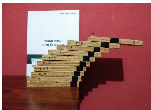
Figura 1: Demonstração com material concreto que pode ser usada em sala de aula para motivar o estudo da série harmônica. O livro serve como referência visual da linha vertical. O bloco com rótulo n = 1 está fora da mesa. Videoaula com cálculos de centro de massa e outros detalhes em (LÓPEZ).
